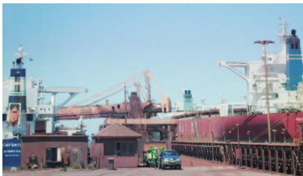
南アフリカの主要8港はすべて、国営運輸公社トランスネットの国家港湾局(TNPA)が所有。サルダナ港は南半球で最大水深23.7mの自然港で、パナマックス船2隻(最大喫水23.5m)の入港が可能なバルクカーゴ専用港。1970年代に鉄鉱石の輸出港として開発され、現在では世界の鉄鉱石輸出額のおよそ5%を占めるアフリカ大陸で最大の鉄鉱石輸出港となっている。特徴は、理想的な港湾の形状と水深に加え、内陸の鉄鉱石採掘現場から861kmにも及ぶ鉄道レールとベルトコンベアーで棧橋の鉄鉱石船積み用バースまでが直接つながっているところである。2つの鉄鉱石(ドライバルク)用と1つの液体バルク用、さらに多目的用と4つのバースを有するが、今後もLPG用の輸入施設やドライバルク用の新たなバースなどを拡張する予定である。
