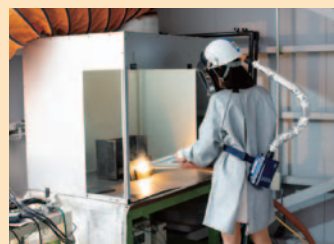
顔と頭にはレーザーの光と熱を防ぐガードを装着。腰の装置からガードに冷風が送られてくるので作業は快適！
