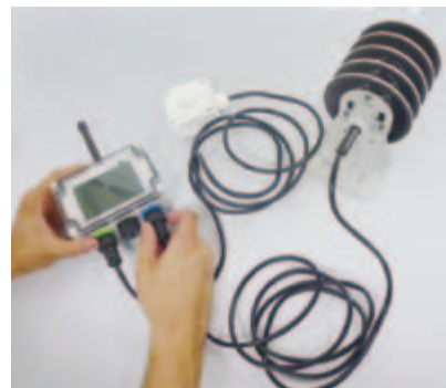
長距離気象センサー・システムNSOS-100。左が送信機、中央が照度センサー、右が温湿度センサー ★
