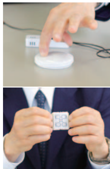
マッシュスイッチの外装(上)と内部(下)。ボタンを4つに分け、照明のON・OFFや明るさの調整などの機能も持たせられる。
