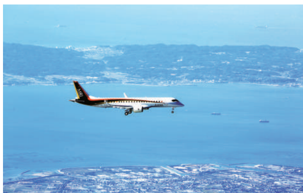
2015年11月11日、大空に飛び立ったMRJ飛行試験機。県営名古屋空港を離陸後、太平洋側の空域を利用し、上昇、下降、旋回などの基本特性の確認を約1時間半かけ実施した 写真提供:三菱航空機(株)
