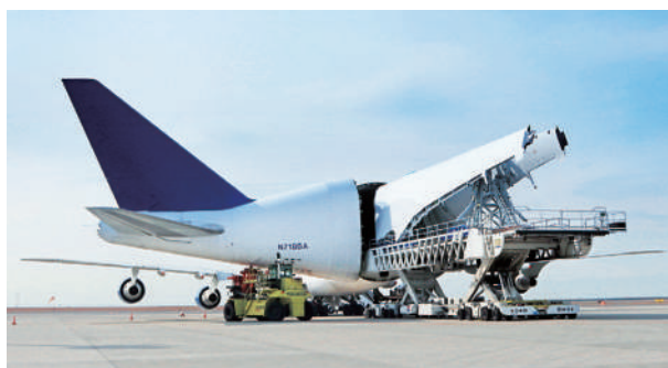
ボーイング787の部品をシアトルの工場まで運ぶためにつくられた貨物輸送機「ドリームリフター」。日本ではセントレアにのみ飛来している
