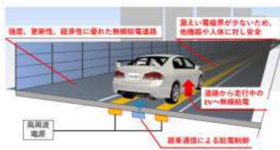
《図表 2-12 国土交通省における走行中給電実用化システム技術開発研究の完成イメージ》
