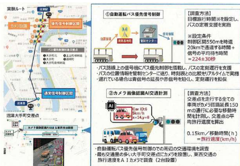
《図表 2-9 沼津市のバス自動運転と優先信号制御実証実験》
