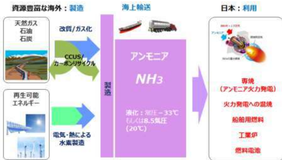
《図表 1-4》 カーボンニュートラルな燃料アンモニアの製造から利用
