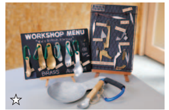
☆ プレスで切り抜いたアルミや真鍮の板を木槌で叩きオリジナルのマイスプーンをつくるメニュー
