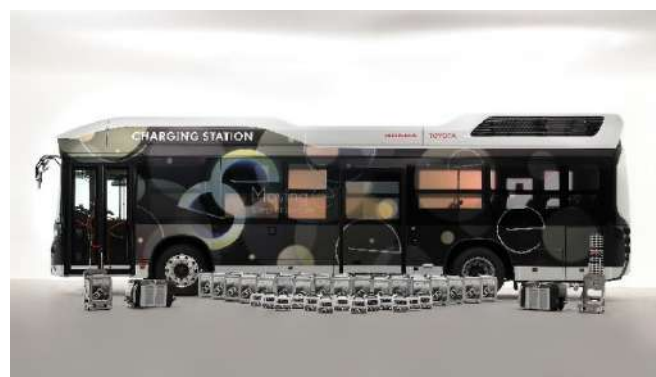
図8 PHVによる外部給電（外部給電器は別売） 図9 燃料電池バスと可搬型外部給電器/バッテリー
