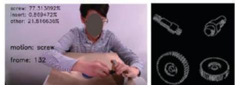
テンプレートマッチング処理と人姿勢認識を組み合わせによる組立作業の観察と自動解釈。(右図:部品のテンプレート画像)
