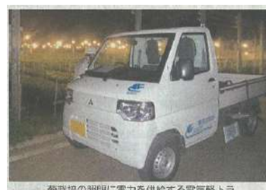
図表 5-10 電照菊の照明に電力を供給するEV軽トラ
