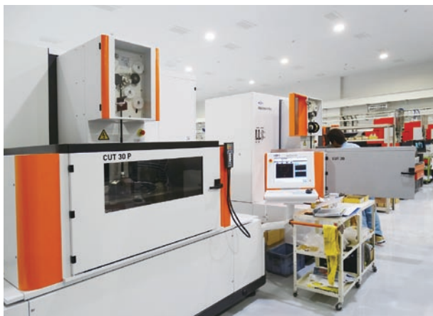
(株)プローチ研削工業所(SOLAEメンバー)に設置された40台を超える放電加工機
